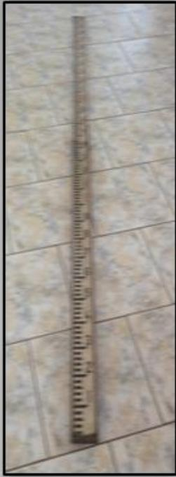
A mira falante ou régua foi adquirida na década de 1970. Régua de madeira graduada em m, dm, cm e mm utilizada na determinação de distâncias horizontais e verticais entre pontos nas aulas de Topografia.
