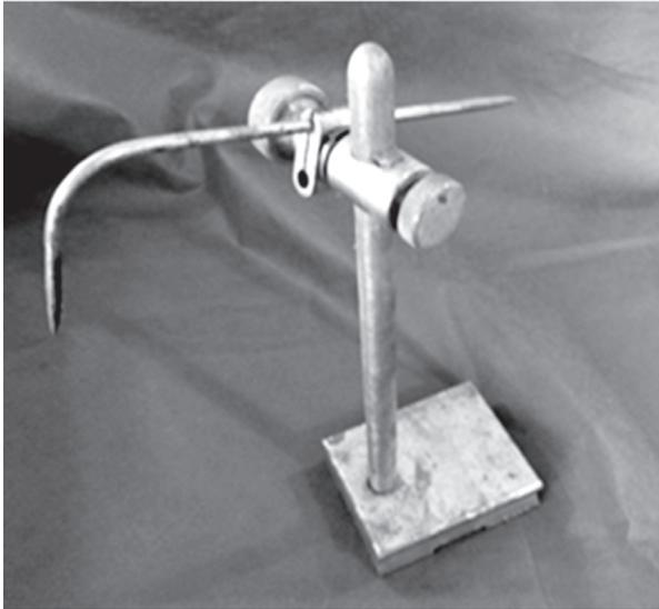
**Figura 1** – Graminho: traçador de peças cilíndricas
