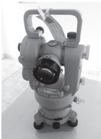
**Figura 16** – Teodolito Óptico Mecânico
