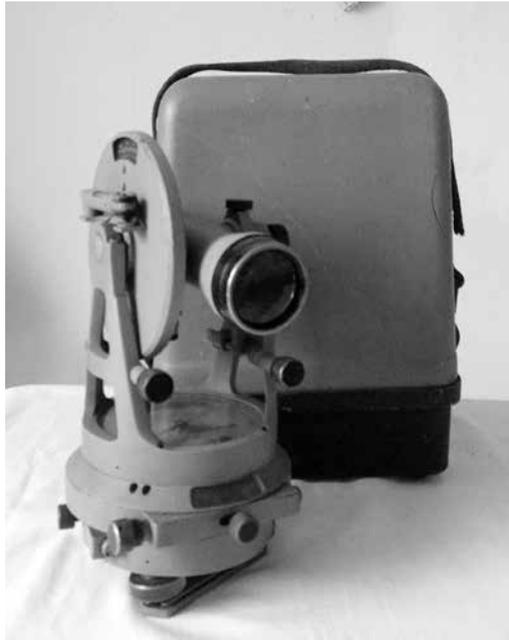
**Figura 3** - Teodolito Ótico Mecânico
