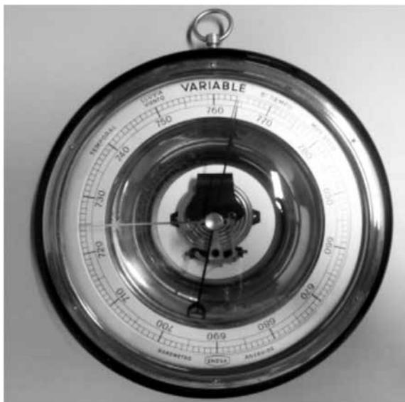
**Figura 4:** Barômetro aneróide
