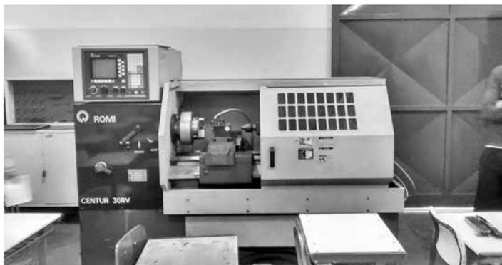
**Figura 7:** Torno CNC modelo Centur 30D da escola Etec Pedro Ferreira Alves
