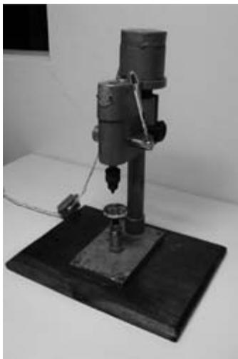
**Figura 3** – Furadeira Elétrica de porte pequeno de 1982 para furar placa de computador
