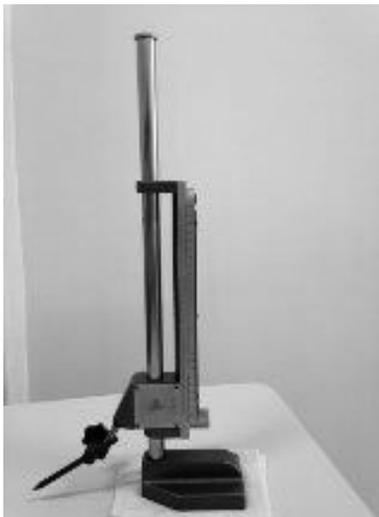
**Figura 5** – Calibrador traçador de altura com ajuste fino. Acervo da Etec Trajano Camargo, em 2014.
