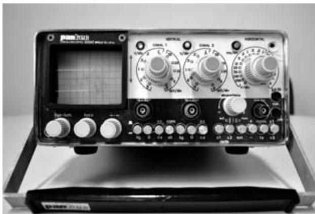
**Figura 4** – Painel Frontal Osciloscópio PANTEC Labo 5100 15Mhz.
