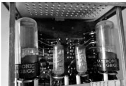
**Figuras 2 e 3** – Circuitos Internos da Fonte de Alimentação Dupla com detalhes das válvulas eletrônicas.
